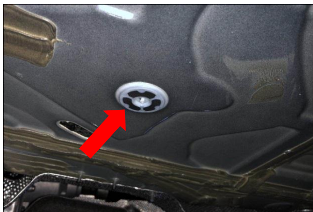
左踏板电机布线：如图此处孔位为左穿线孔
